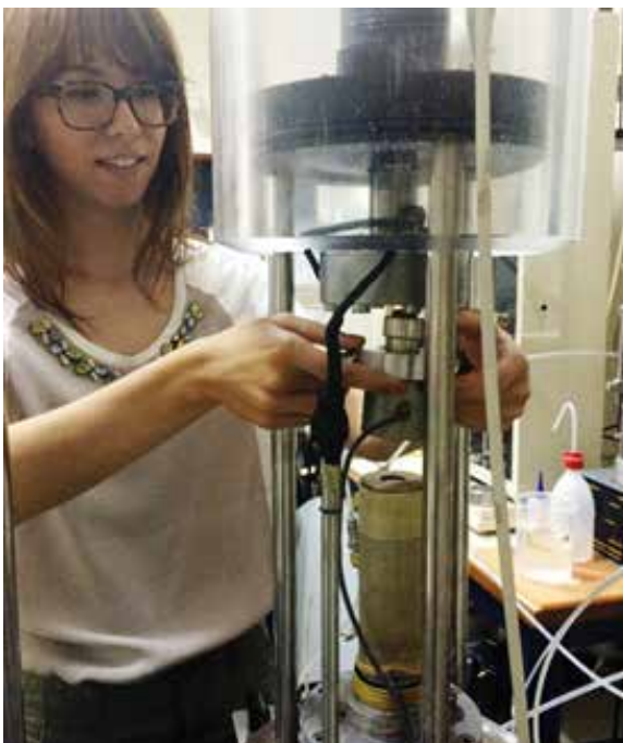
Σχήμα 3: Η κ. Αντιγόνη Βράννα, υποψήφια διδάκτορας, προετοιμάζει κυλινδρικό δοκίμιο σταθεροποιημένου άμμου στη συσκευή ανακυκλικής τριαξονικής φόρτισης.
